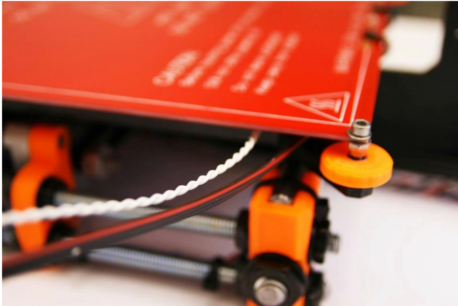
Pict. 22 -Cables listos para envolver con la cobertura en espiral.
