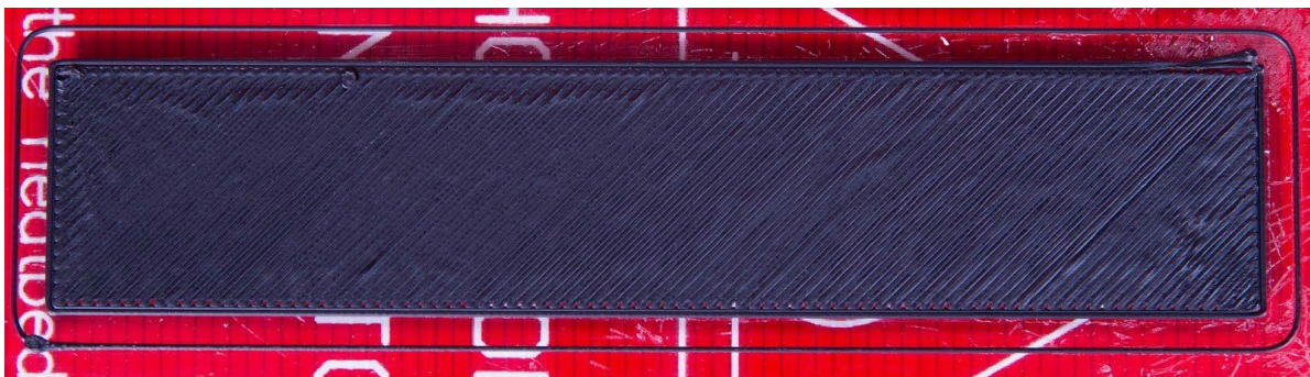
Pict. 6b - Impresión calibrada muestra un flujo de filamento constante.
