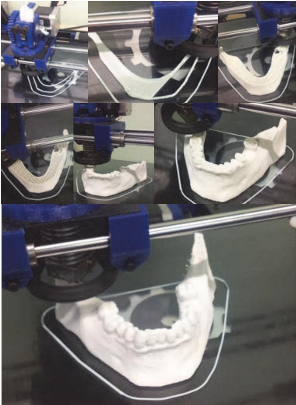
Figura 20.9. Impresora 3D RepRapBCN. Modelo impreso en EUETIB (UPC).
