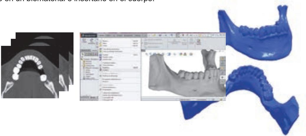
Figura 20.1. Reconstrucción e impresión 3D a partir de Tomografía (TAC) o Micro-Tomografía ( $\mu$ CT).
