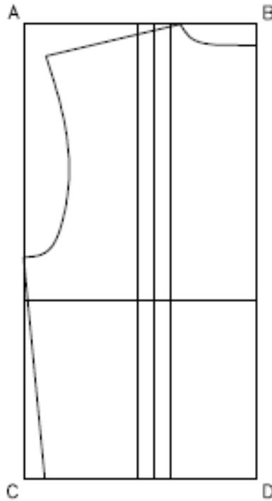
17. Con el comando Línea dibuje la pinza de talle tal como se muestra en la figura.
