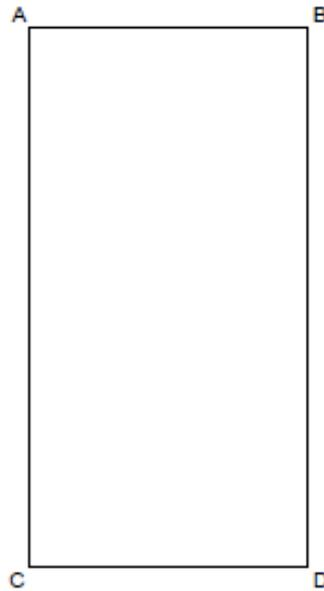
2. Con el comando Paralelas dibuje una paralela a BD a una distancia de 7.25. Repita el comando y dibuje una paralela a AB a 2.00.
