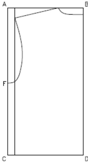
13. Con el comando Línea dibuje una línea desde F hasta la intersección de la paralela con CD.
