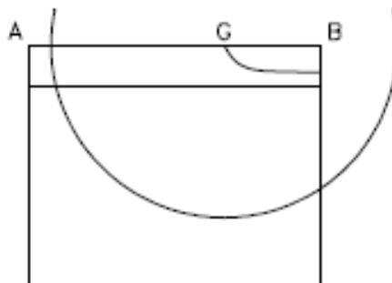
6. Con el comando Línea dibuje una línea desde el punto G hasta el punto H, intersección del círculo con la paralela.
