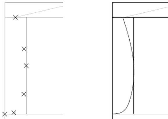
11. Una vez dibujada la curva, ajuste su forma con los pinzamientos. Con el comando. Borrar elimine las paralelas dibujadas anteriormente.
