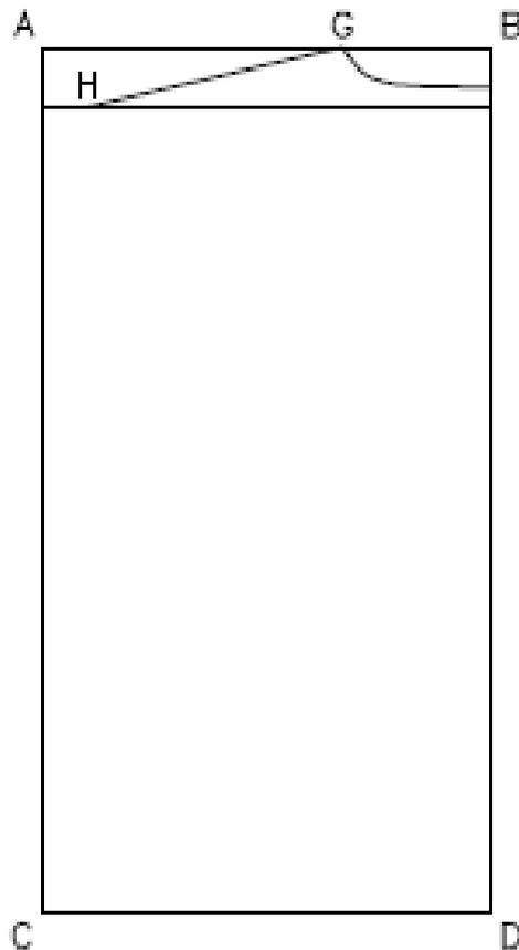
8. Con el comando Paralelas dibuje una paralela a AB a una distancia de 22.00. Repita el comando y dibuje una paralela a AC a 4.25.
