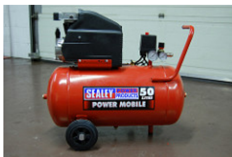
Compresor y depósito
