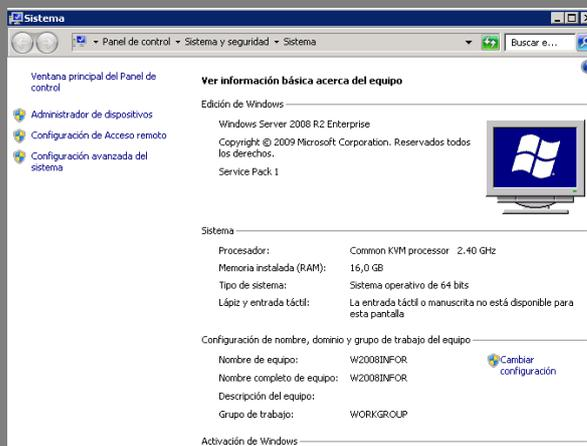
Procesador KVM esto significa: máquina virtual basada en el núcleo, y es una solución para la virtualización completa.
