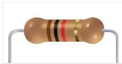
Las líneas de colores que una resistencia tiene dibujadas externamente permiten calcular su valor en Ohmios siguiendo el siguiente Código de Colores:
