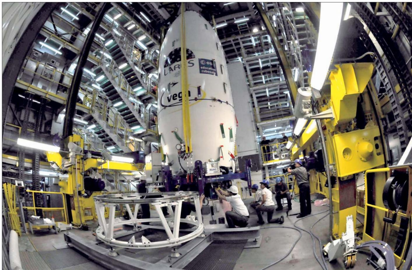
Montaje sobre el cohete de los satélites que pondrá en órbita Vega dentro de la torre de lanzamiento. /ESA/M. PEDOUSSAUT
