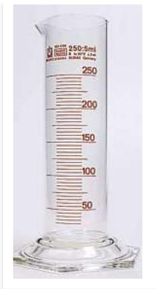
Anotamos lo que marcan dos medidas contiguas; por ejemplo, en la probeta de la foto: 200 y 250 mL. Calculamos la diferencia: 50 mL.
