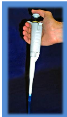
Figura 5. Pipeta de disparo para manejar volúmenes en microlitros (20 a 500 \mu l), utilizada en los análisis en microescala.
