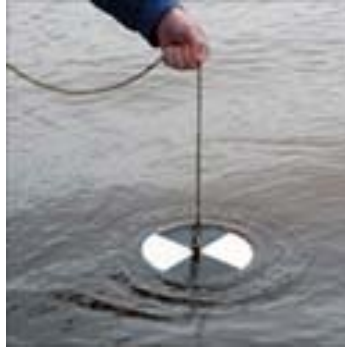
Figura 2. Empleo del Disco de Secchi, para medir la Turbidez en la columna del agua, que se debe a las partículas en suspensión.
