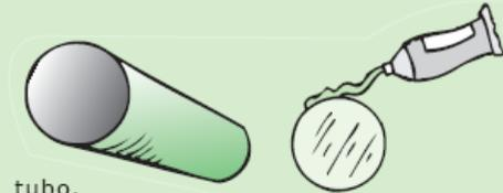
2. Aplica un adhesivo para plástico al interior del tubo y también al borde del círculo, coloca la ventana (círculo) en posición.
