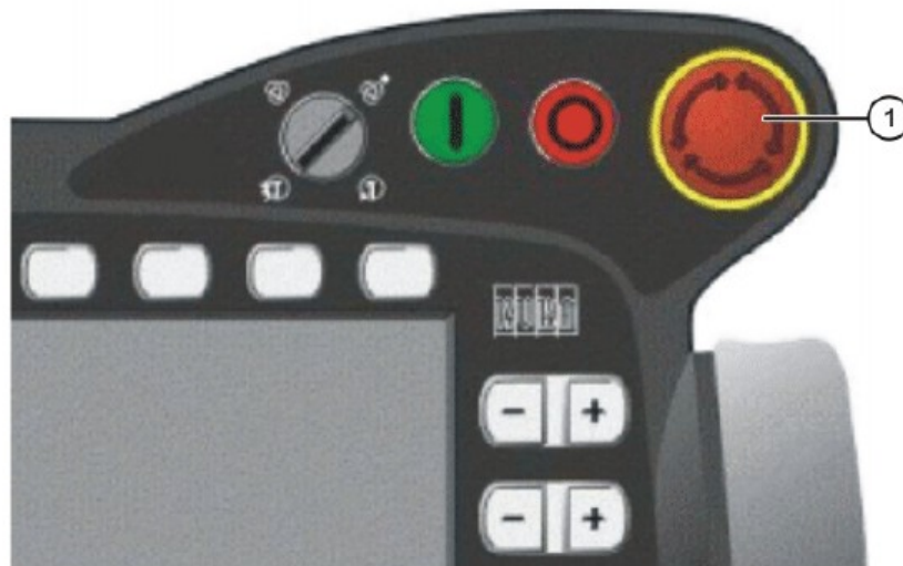
Fig. 3-2: Pulsador de PARADA DE EMERGENCIA en el KCP
