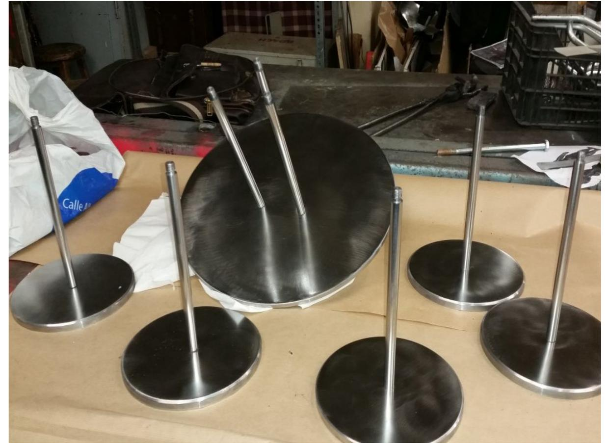
Ya hemos acabado las bases metálicas confeccionadas en chapa de 10 mm de grosor, torneándolas para darles la forma redonda y mecanizándolas para la sujeción de las distintas piezas mediante varillas.
