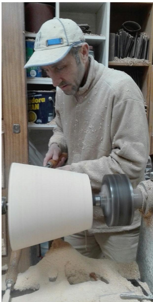
Una vez aplicada la lija al contorno, se procedió a preparar la pieza cónica para prevenir un posible accidente y poder cortarla con la inclinación deseada.
