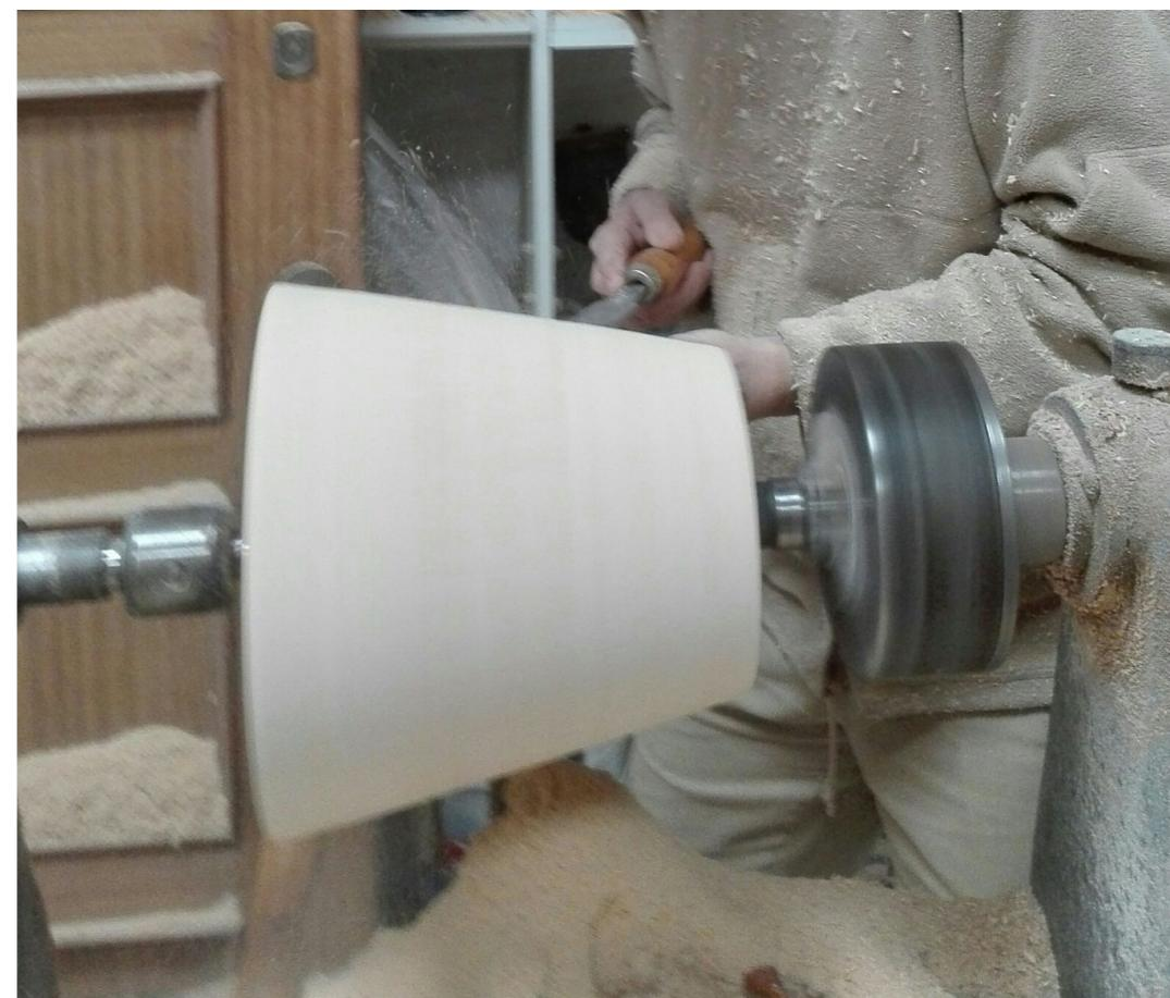
Tras el torneado, a una de las tres copas, debido a requerimientos del diseño, exigía darle un corte axial en oblicuo, por lo tanto se ha tenido que atornillar un tablero y un listón sujetado con dos gatos con la finalidad de poder tener un punto de apoyo para así poder cortar evitando cualquier riesgo de corte.
