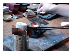
j. Se vuelca la plata en estado líquido en el molde de sepia, este procedimiento debe hacerse con precisión y rapidez puesto que la plata al no recibir calor se solidifica.
