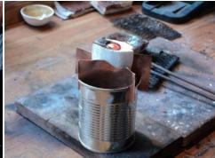
k. tirar el molde al agua para que se enfrié, abrir el molde y dejar caer la pieza en el agua para que termine de enfriarse el metal. Sacar el anillo del agua.
