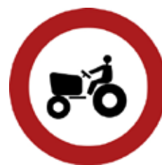
Figura 9. Señal de prohibición de circulación de vehículo agrícola.
