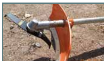
Figura 28. Detalle de protector de elemento de corte.
