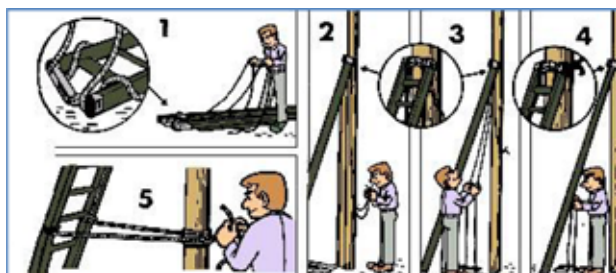
Figura 46. Procedimiento a seguir para asegurar una escalera a un árbol.
