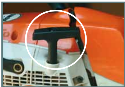
Figura 19. Detalle de mando unificado de arranque y parada de motosierra.
