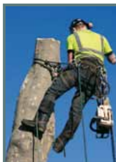
Figura 49. Motosierra sujeta a cinturón del arnés..
