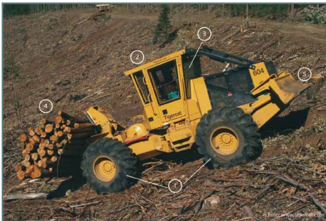
Figura 29. Elementos de seguridad de tractor forestal.
