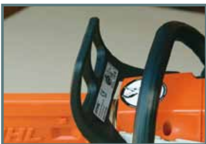
Figura 21. Detalle de mandos de mano izquierda de motosierra.
