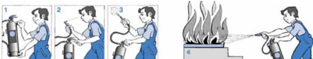
Figura 17. Pasos a seguir en la utilización de un extintor.
