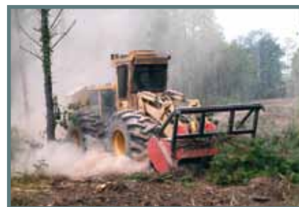
Figura 34. Desbrozadora acoplada a la toma de fuerza de tractor.
