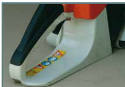
Figura 23. Detalle de protector de mano derecha de motosierra.
