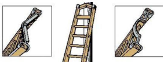
Figura 47. Elementos especiales para apoyar la escalera a un árbol.
