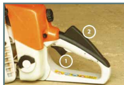
Figura 22. Detalles de mandos de mano derecha de motosierra.
