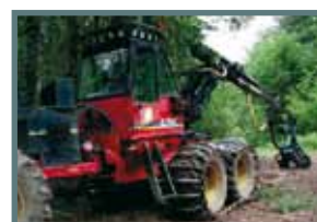
Figura 7. Procesadora con cabezal apoyado en el suelo.
