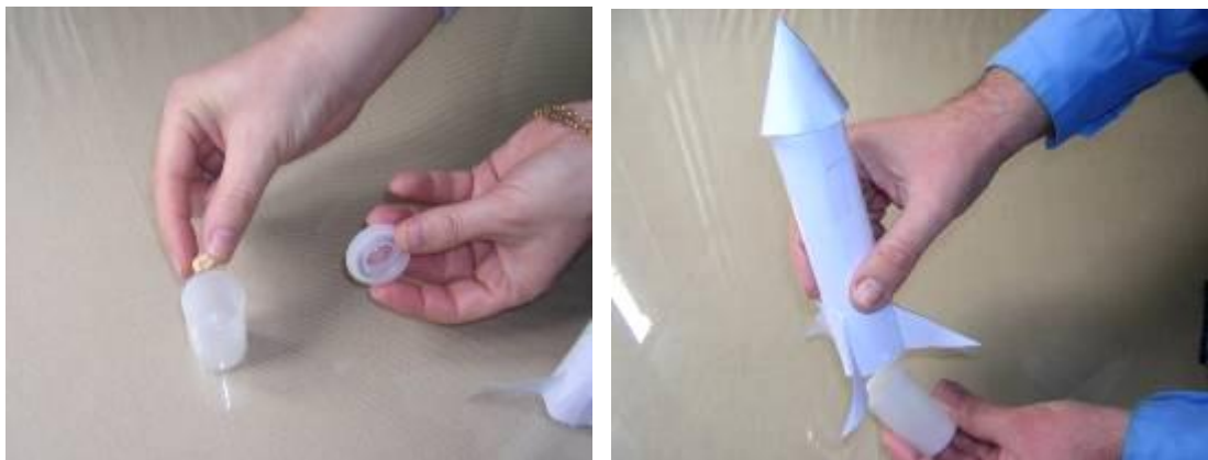
Fig. 1 y 2: Introduciendo la pastilla efervescente en la capsula de plástico de un rollo de película, y después en el modelo de cohete.
