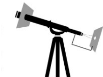
Fig. 10a: Observación solar por proyección con un telescopio (nunca se debe mirar directamente al Sol)
