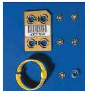
Dosímetro de anillo diseñado para la medida de dosis localizada en los dedos
