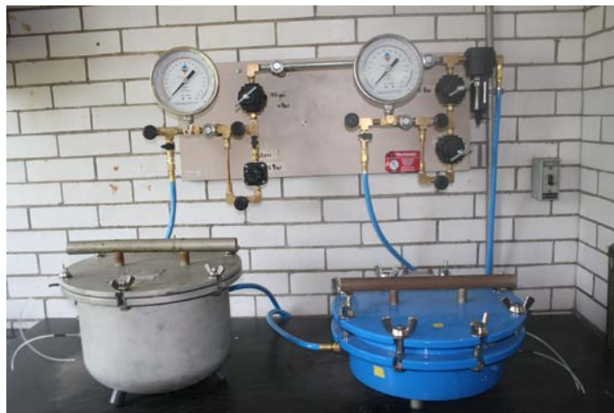
Figura 4.6.2. Membrana y olla de presión
