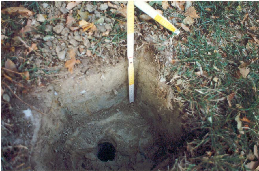
Figura 5.4.2.2.1. Pozo para medir conductividad hidráulica
