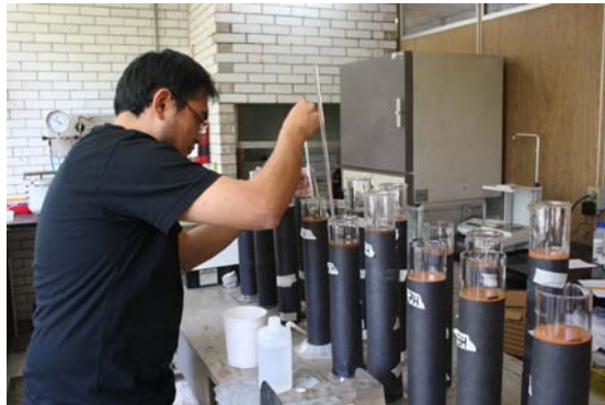
Figura 4.5.2. Suspensión de suelo en probetas de 1000 cc
