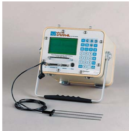
Figura 5.2.1. Equipo Trase con sistema TDR
