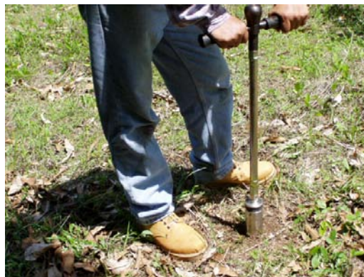
Figura 5.1.1. Barrena de muestreo
