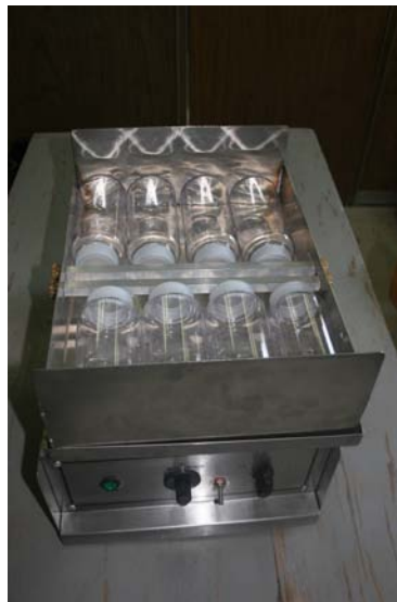
Figura 4.5.1. Agitador de motor para dispersión con botellas de plástico
