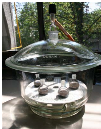
Figura 4.2.2. Desecador con vacío
