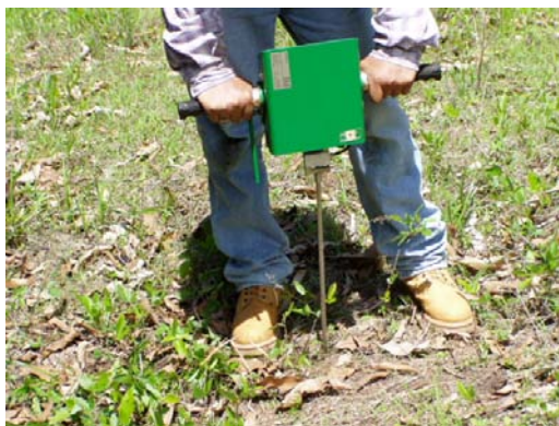
Figura 5.3.1. Penetrómetro de ultrasonido
