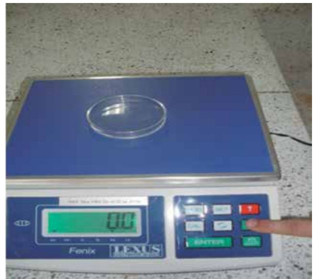
Coloque el recipiente en el que va a realizar el pesado en el plato de la balanza y a continuación oprima el botón de tarado. En la pantalla debe aparecer el valor 0.0.
