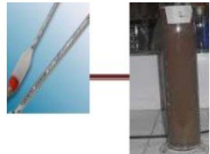
7. Colocamos el hidrómetro, y agitamos la muestra hasta la **homogeneización**.
