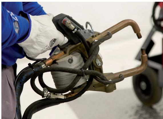
del punto. El diámetro que ha de tener la punta, está determinado por el espesor de las chapas a soldar, A mayor espesor, mayor diámetro deberá tener la punta. La posición de los electrodos también influye, deben estar correctamente alineados, enfrentados y limpios para que se establezca el contacto en las superficies de soldeo.
