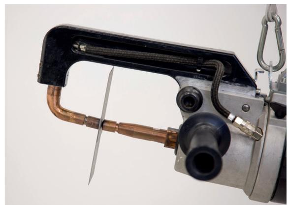
**Fase de soldadura.** Es el tiempo durante el cual pasa la corriente eléctrica a través de los electrodos y chapas, mientras se mantiene presión entre ellos. Es el momento en que el material de las chapas a soldar se lleva a su estado de fusión. En esta fase la presión de los electrodos es ligeramente menor que en la primera fase con el fin de facilitar el paso de la corriente eléctrica.
