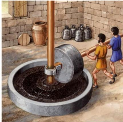
una o dos muelas con forma de cilindro atravesadas por su centro, se construían con piedras como el granito. A estas piedras se les ejerce un fuerza de rotación y translación haciendo que la piedra se desplace y realice su acción en la aceituna molida.
