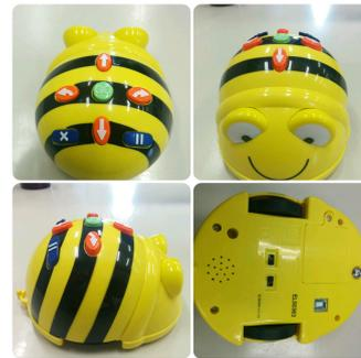
Estos robots pueden ejecutar secuencias de movimientos que son programadas de forma sencilla por el usuario mediante la pulsación de las teclas del robot.
