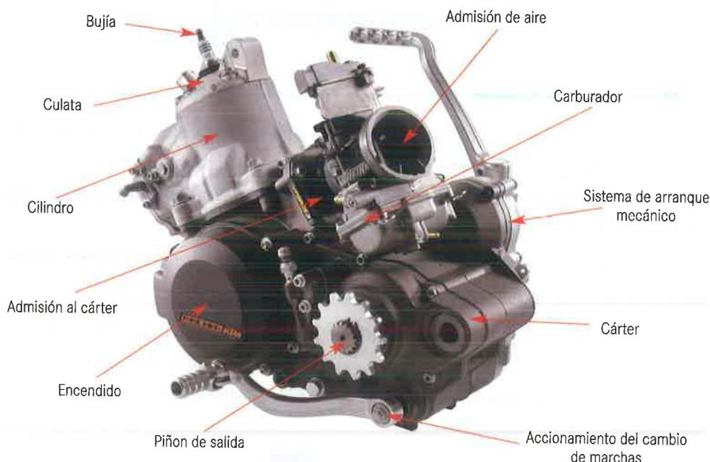
Motor monocilíndrico 2T
