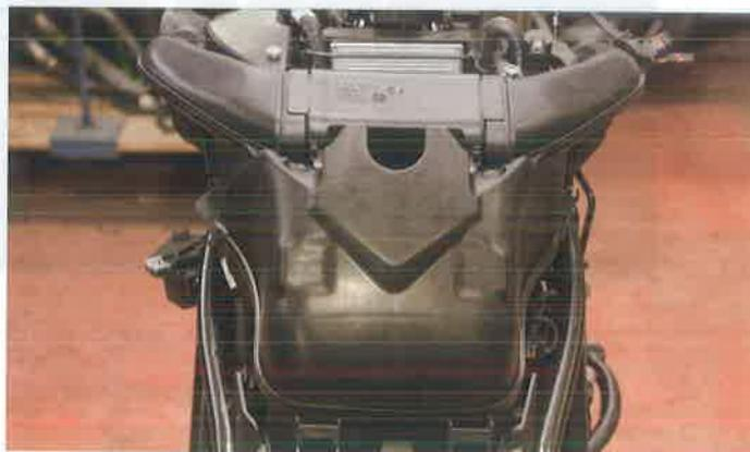
*Sistema de admisión con canalización del filtro de aire*
