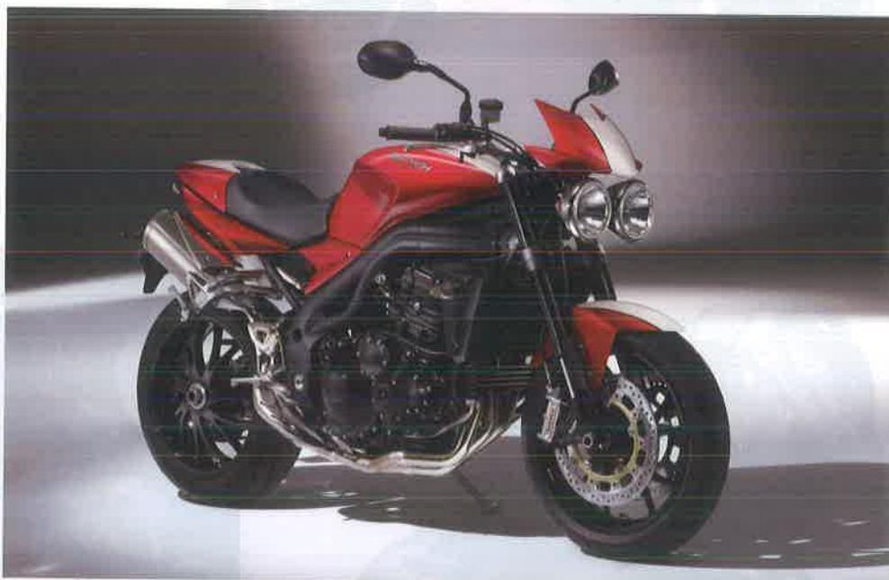
*Triumph Speed Triple con motor tricilíndrico*
