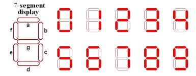
A cada número corresponde un conexionado distinto de 7 leds. Por ejemplo, al "1" le corresponde activarse el b y c, mientras que el "8" los tiene todos conectados.
