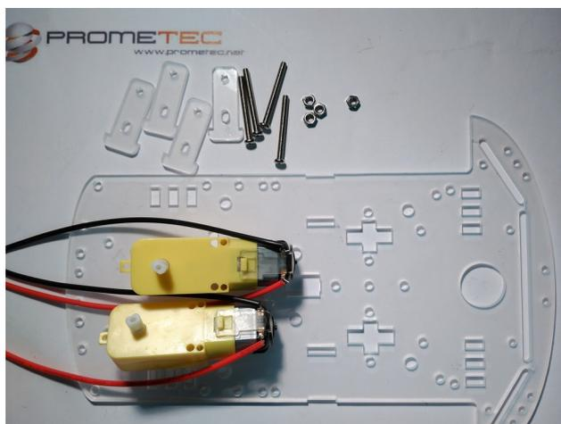
Colocamos una de las piezas de plástico en uno de los dos agujeros rectangulares que hay en la zona central del chasis, y otra en la parte exterior que tiene una hendidura paralela a la que hemos colocado en el interior, con el motor en medio de ellas
