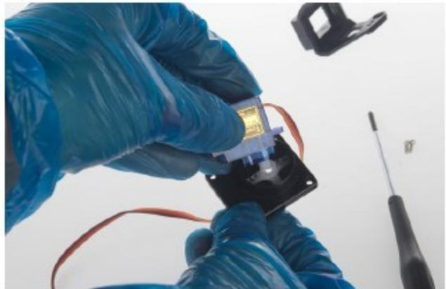
Después encajamos en los dos laterales las piezas que faltan y las atornillamos con dos tornillos:
