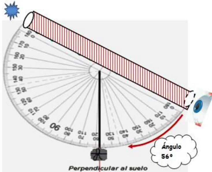
Dirija el astrolabio usando la mira (pitillo) hacia una de las estrellas seleccionadas y mida el ángulo, cuyo valor es la altura de la estrella, como muestra la figura. Repita nuevamente la medición para confirmar el dato y regístrelo en la tabla.
