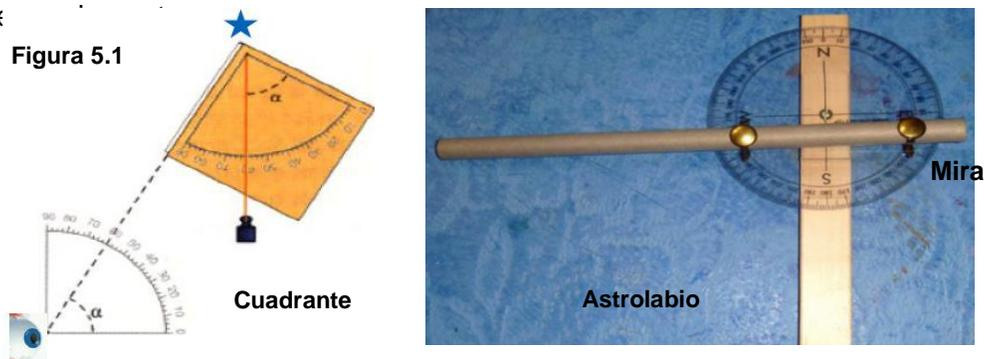
Se debe apuntar el pitillo hacia la estrella a la cual se le desea determinar la altura; esta medición se repite con la misma estrella en intervalos de media o una hora, según el tiempo dispuesto por el docente y se registran en la guía, el docente debe rotar por los grupos aclarando dudas y verificando el buen uso de los instrumentos.
