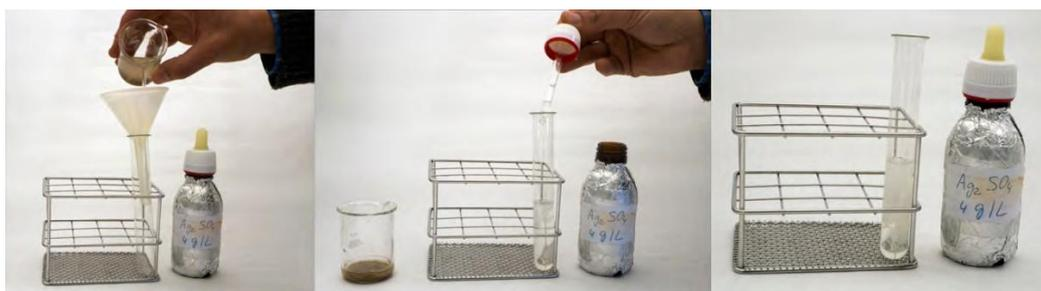
Figura 15. Una vez filtrado el extracto del suelo (izquierda), se le añaden unas gotas de la disolución de AgSO<sub>4</sub> 4,4 g l<sup>-1</sup>, que desencadena la formación y precipitación de AgCl<sub>2</sub>, apreciable por la aparición de turbidez blanquecina.
