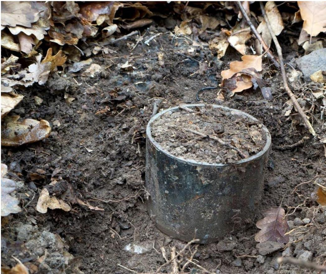
Figura 9. Una vez clavado el cilindro en el suelo, debe excavar a su alrededor para su extracción evitando que la muestra se caiga por la parte inferior del cilindro.
