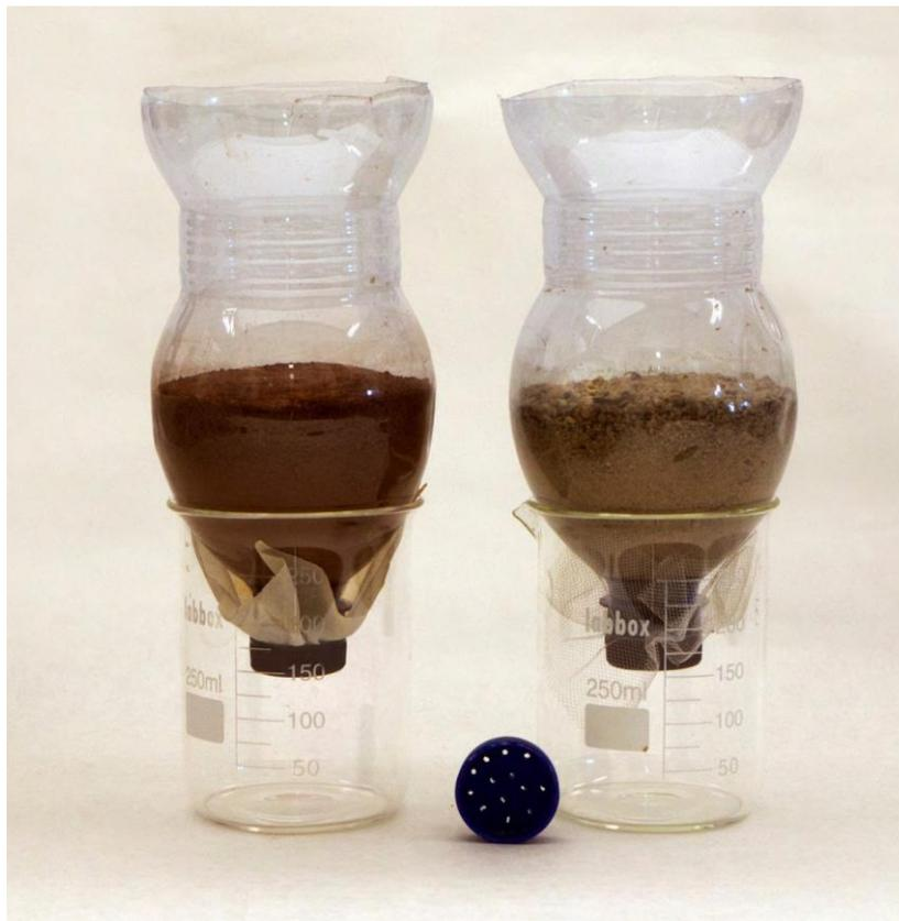
Figura 21. Columnas de percolación preparadas y listas para su uso. En la parte central se aprecia el tapón con los agujeros para facilitar la evacuación del agua. En este caso, la columna de la izquierda contiene un suelo arcilloso y el de la derecha un suelo arenoso.
