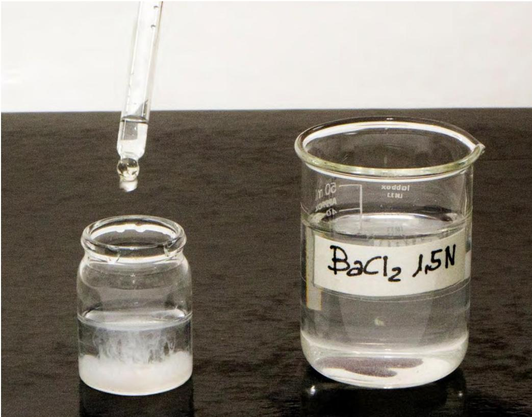
Figura 17. Después de unos días de incubación, el vaso que contiene la disolución de NaOH también contiene  $\text{Na}_2\text{CO}_3$ , gracias a la respiración del suelo. Al añadir unas gotas de la disolución de  $\text{BaCl}_2$ , se forma  $\text{BaCO}_3$  que, al ser insoluble en agua, origina el precipitado blanquecino que se observa en la foto.
