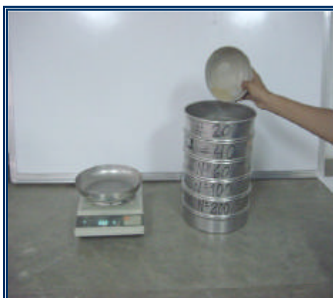
Figura 13 Separación del material en los tamices y pesada de la fracción retenida
