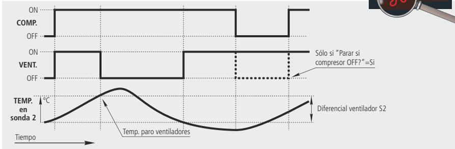
El control de los ventiladores se realiza mediante la sonda 2 y teniendo en cuenta los siguientes parámetros:
