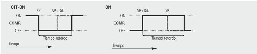
Si la sonda 1 falla (avería, desconexión, etc. ), el compresor funciona según los tiempos programados en los siguientes parámetros:
