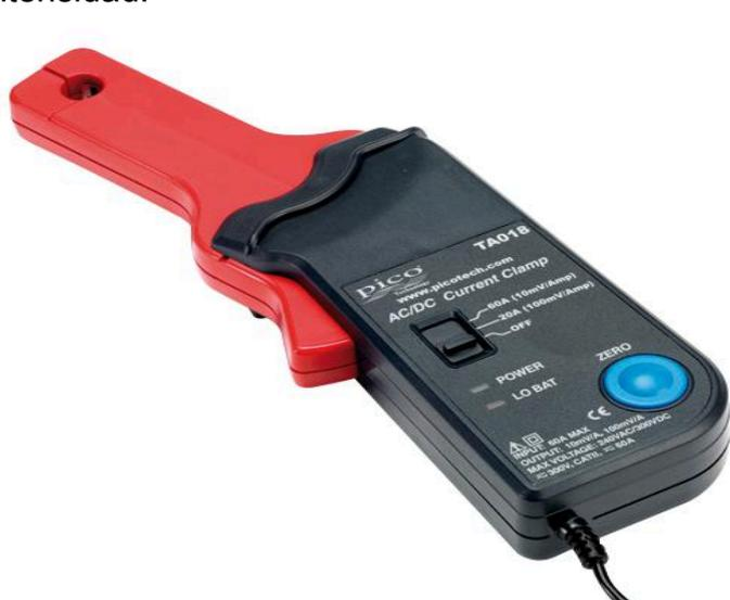
En primer lugar antes de conectar la abrazadera se debe pulsar el botón “zero” para que la medida sea correcta y evitar posibles interferencias, posteriormente se conecta al cable de activación de la bobina correspondiente, en este caso en el **pin 1**.
