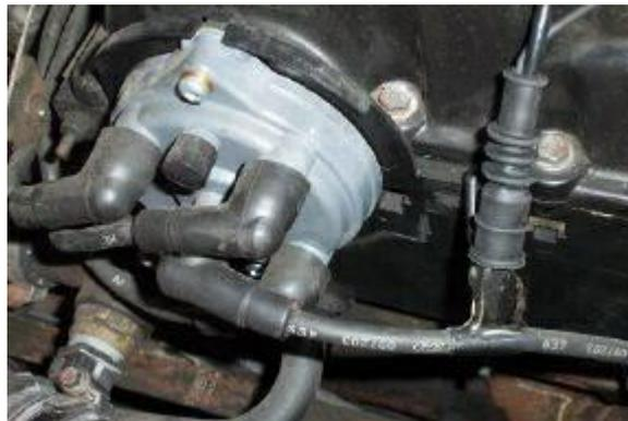
Figura 2. Terminal del lector de encendido secundario conectado al terminal de la bobina del distribuidor.
