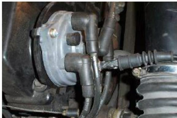
*Figura 1. Terminal del lector HT conectado a uno de los terminales de las bujías.*
