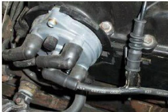
*Figura 1. Muestra el terminal del lector HT conectado al terminal de la bobina del distribuidor.*
