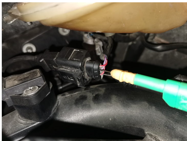
Conexión de las puntas de prueba en el conector
