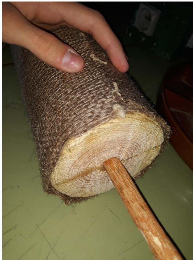
Cosido de la primera tela arpillera alrededor del molde.
