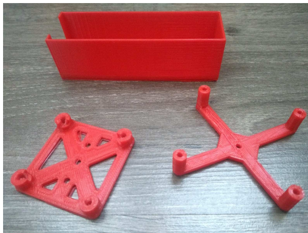
Foto 6. Pieza para power bank y diseños para puente H
