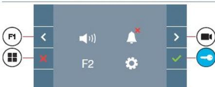
El monitor VEO XS incorpora un menú OSD que se gestiona a través de los pulsadores del monitor para acceder a las funciones de uso y programación del terminal. Los iconos visualizados en pantalla se manejan con los pulsadores correspondientes ubicados en el monitor.
