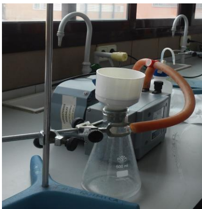
Filtración a vacío
