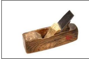
**Cepillo:** tiene una longitud entre 200 y 300 mm y cuenta con una o dos cuchillas. Puede ser de madera o metal.
