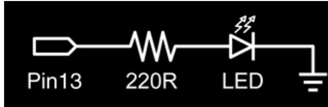
Conexión de un diodo Led a una salida de Arduino
