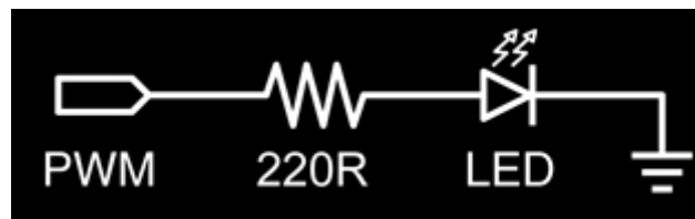
Conexión de una salida analógica a un LED
