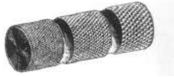
Este mecanizado, denominado moleteado, se realiza sin arranque de viruta con la ayuda de unos rodillos llamados moletas. Estas se fabrican en acero templado de gran dureza, y llevan talladas en su superficie exterior las estrías que deberán grabar al rodar a gran presión sobre la superficie que se ha de moletear.
