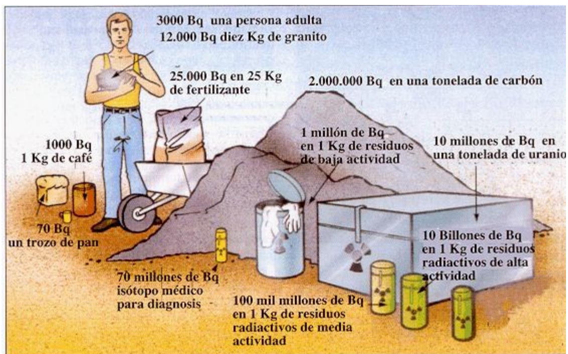
Figura 10.- Contenido radiactivo (en Becquerel, o desintegraciones por segundo) de distintos materiales naturales y artificiales.
