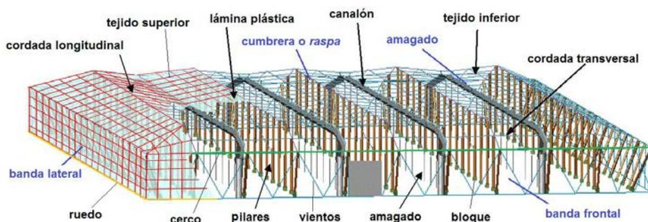
Con respecto a los invernaderos planos se aumenta la altura máxima del invernadero en la cumbreira, que oscila entre 3 y 4,2 m, formando la «raspa». En el «amagado» se unen las mallas de la cubierta al suelo mediante vientos y horquillas de hierro que permiten colocar el tubo de desagüe del agua de lluvia. La altura del amagado oscila de 2 a 2,8 m y la de las bandas entre 2 y 2,5 m.
